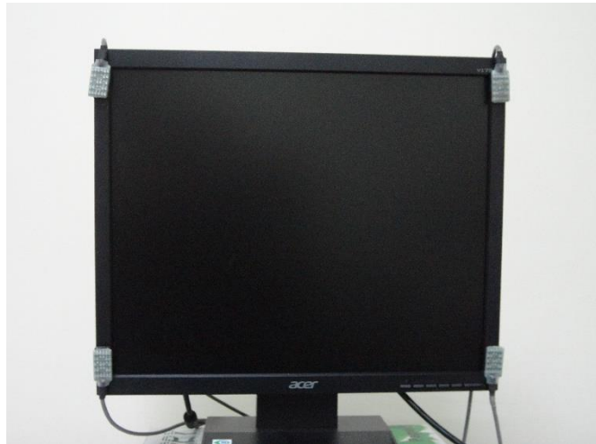
Display PC 與刺激呈現螢幕。螢幕四個角落四個 sensors，用以定位受試者頭部位置。
