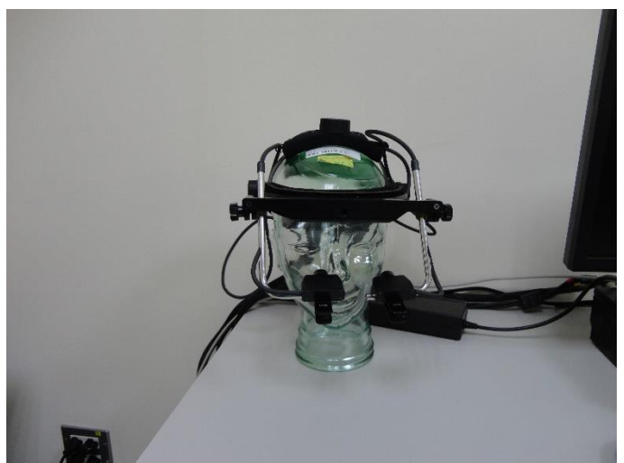
EyeLink II 眼動儀(左圖將眼動儀改設於下巴架上，右圖為頭戴式)
