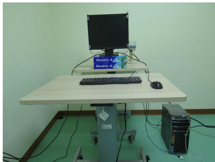
電動升降桌。可依據受試者身高不同，而調整桌面高度。
